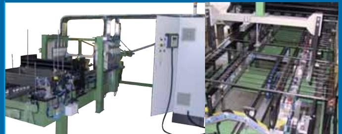
Linea per la foratura e saldatura anelli
